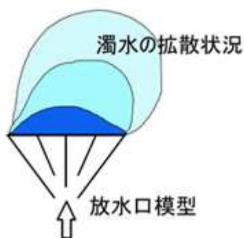
図-5 揚水運転時の水流の挙動説明模式図
