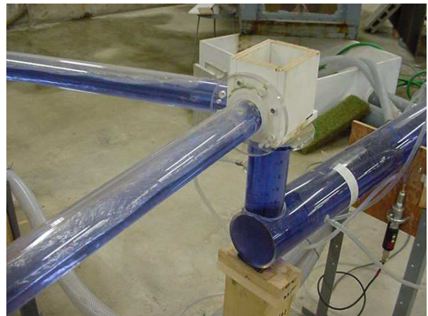
図-6 サイホン放流口模型（末端）
