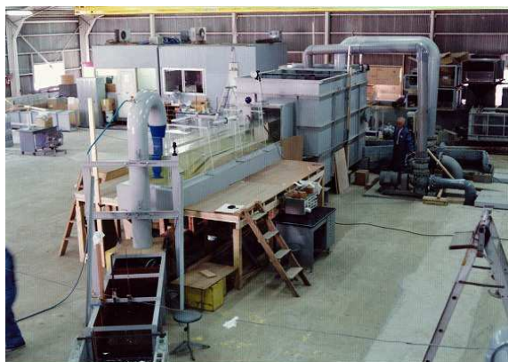
図-1 ポンプ取水槽の水理模型実験例①
