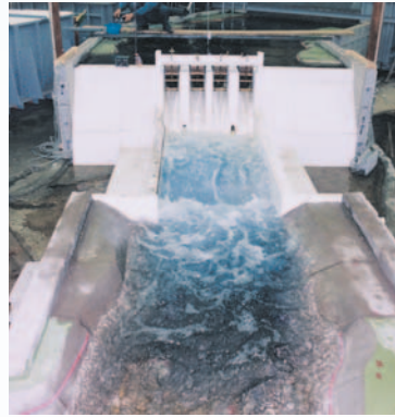
水理模型実験 (電力中央研究所保有設備)
