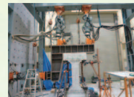
水路構造物の載荷試験 (電力中央研究所保有設備)
