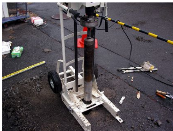
図-5 ネコドリルによる土壌試料採取
