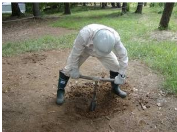
図-4 ハンドオーガによる土壌試料採取
