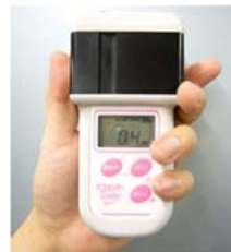
図-4 環境省マニュアル3.3.1法に使用するPCBバイオセンサー
