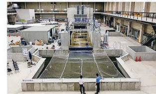
津波・氾濫流実験 (電力中央研究所保有設備)
